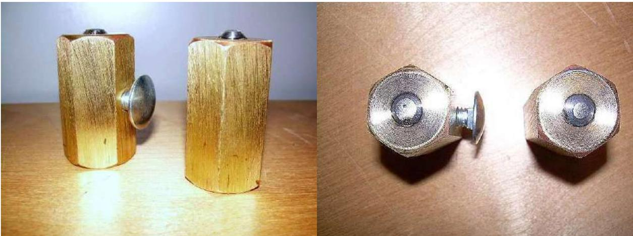
I "SAFETY GAPS" sono elettrodi di scarica in aria e servono da protezione alle extratensioni, sono da collocare in parallelo a tutti i condensatori nonché al NTS, calcolando il "gap" come segue: la distanza tra le punte e' pari alla tensione RMS del NST (tensione efficace per radice di due = valore di picco) maggiorata di un 10% ( $V_{\text{picco}} \times 1,1$ ), per evitare scariche in regime operativo, il tutto diviso per 1100 V/mm di rigidità dielettrica dell'aria "umida".
