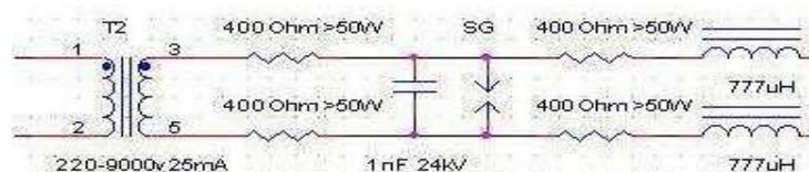
Filtro RF usato nel prototipo
