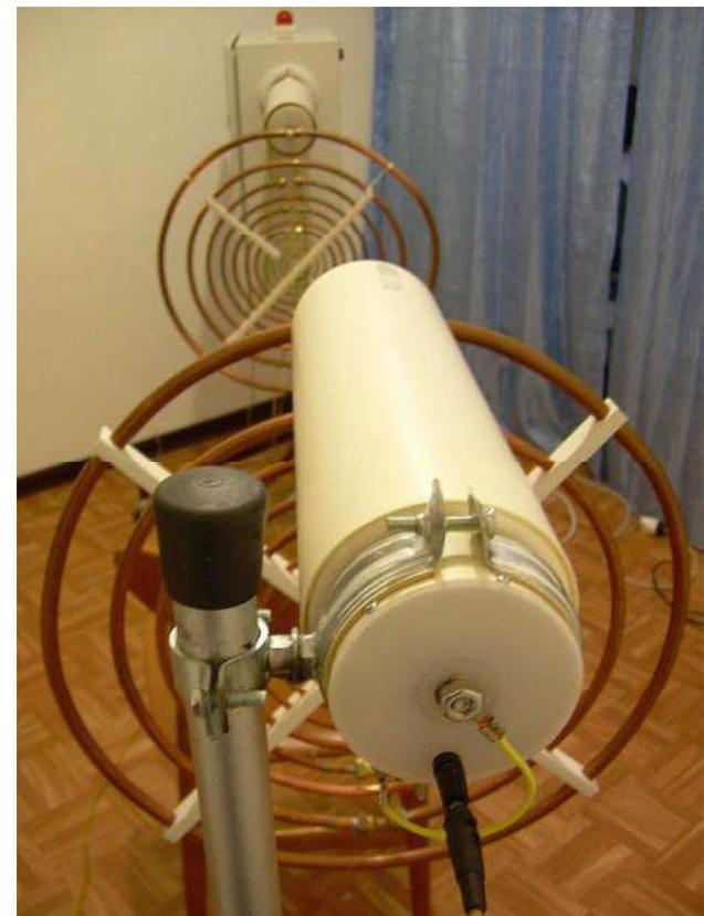
Per l'analisi del funzionamento MWO si pone l'oscilloscopio qualche metro dietro al coil Tx e si collega un'antenna per la verifica del segnale emesso dallo stesso.
