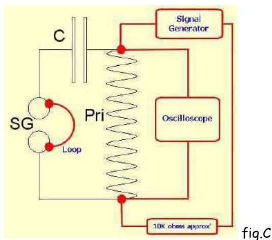
Così facendo trovo la frequenza di risonanza del sistema. Con frequenza generata di 705kHz ho centrato il picco di ampiezza del segnale rilevato in parallelo a L-C regolando il ponticello sulla spira n. 5.5 del primario.
