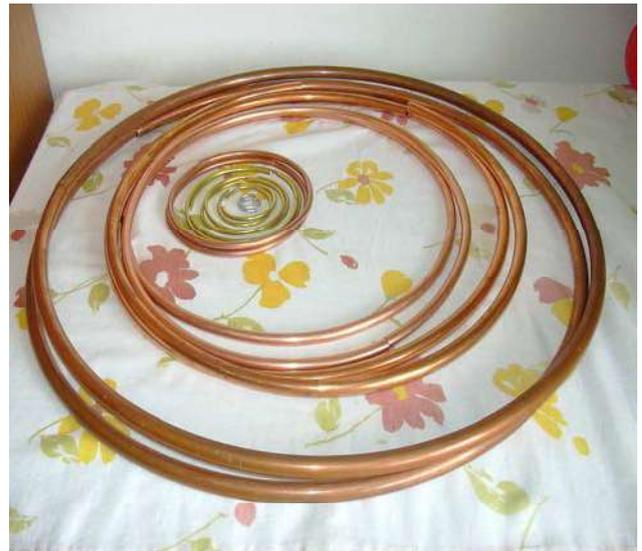
I singoli anelli sono mantenuti concentrici grazie a dei supporti realizzati forando delle barre a "U" in P.V.C. neutro, mentre il collegamento con i dadi cechi è stato fatto tramite stagnatura eseguita con saldatore a fiamma (vedi allegati).
